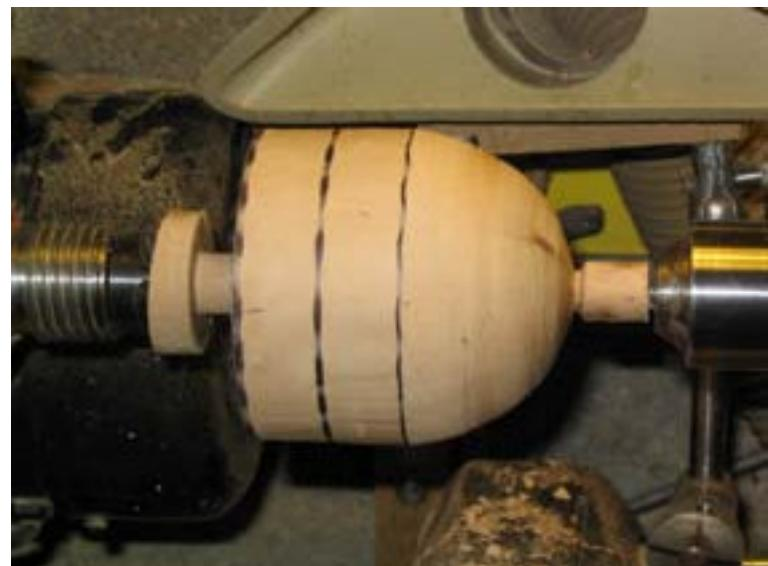
A l' aide d' une gouge à profiler bien affûtée, arrondir les intersections des chanfreins, par passes légères, en talonnant.
